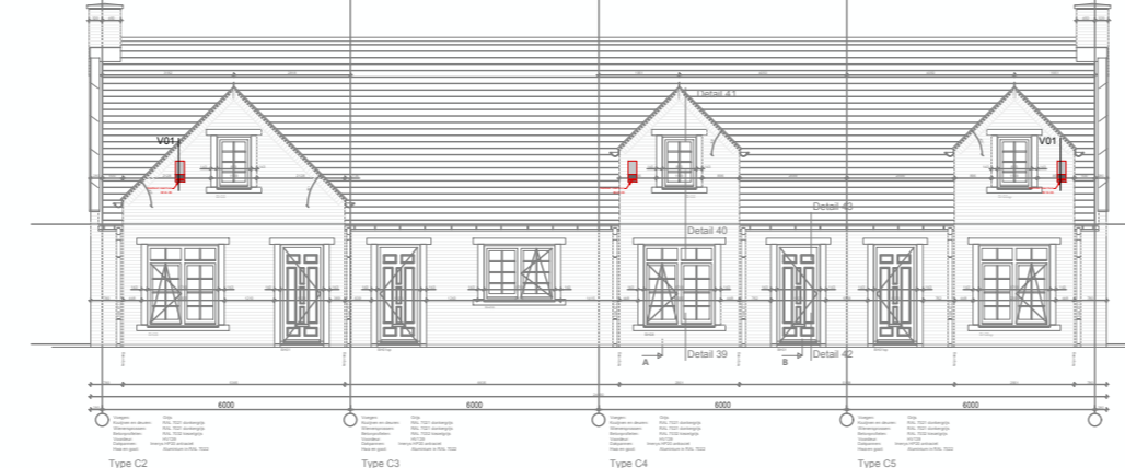
tpv voor- en achtergevel vogelschroten 1 pan hoger aanbrengen tbv nestlocatie huismussen, zie detail V07
