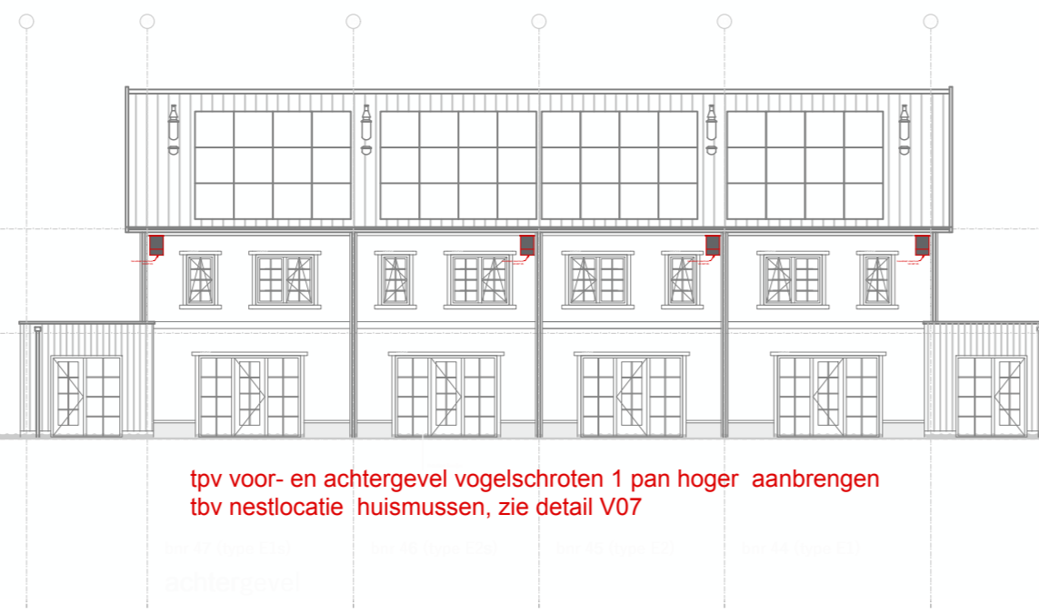
tpv voor- en achtergevel vogelschroten 1 pan hoger aanbrengen tbv nestlocatie huismussen, zie detail V07
