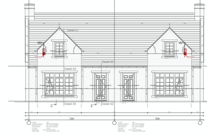
tpv voor- en achtergevel vogelschroten 1 pan hoger aanbrengen tbv nestlocatie huismussen, zie detail V07
