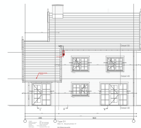
tpv voor- en achtergevel vogelschroten 1 pan hoger aanbrengen tbv nestlocatie huismussen, zie detail V07
