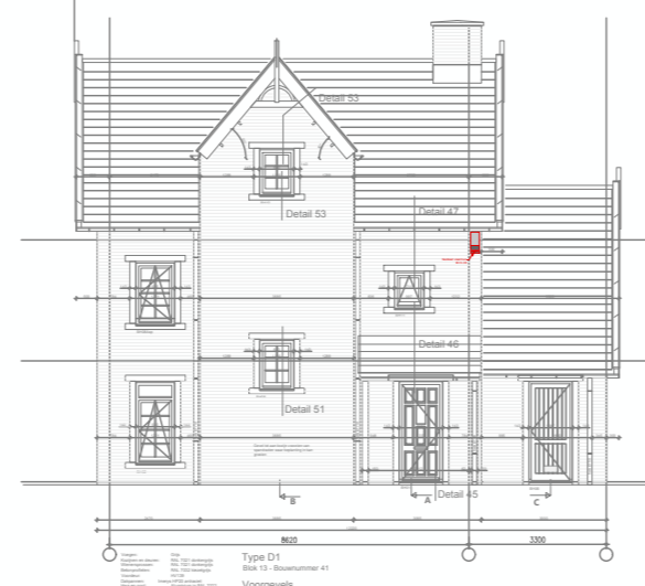
tpv voor- en achtergevel vogelschroten 1 pan hoger aanbrengen tbv nestlocatie huismussen, zie detail V07
